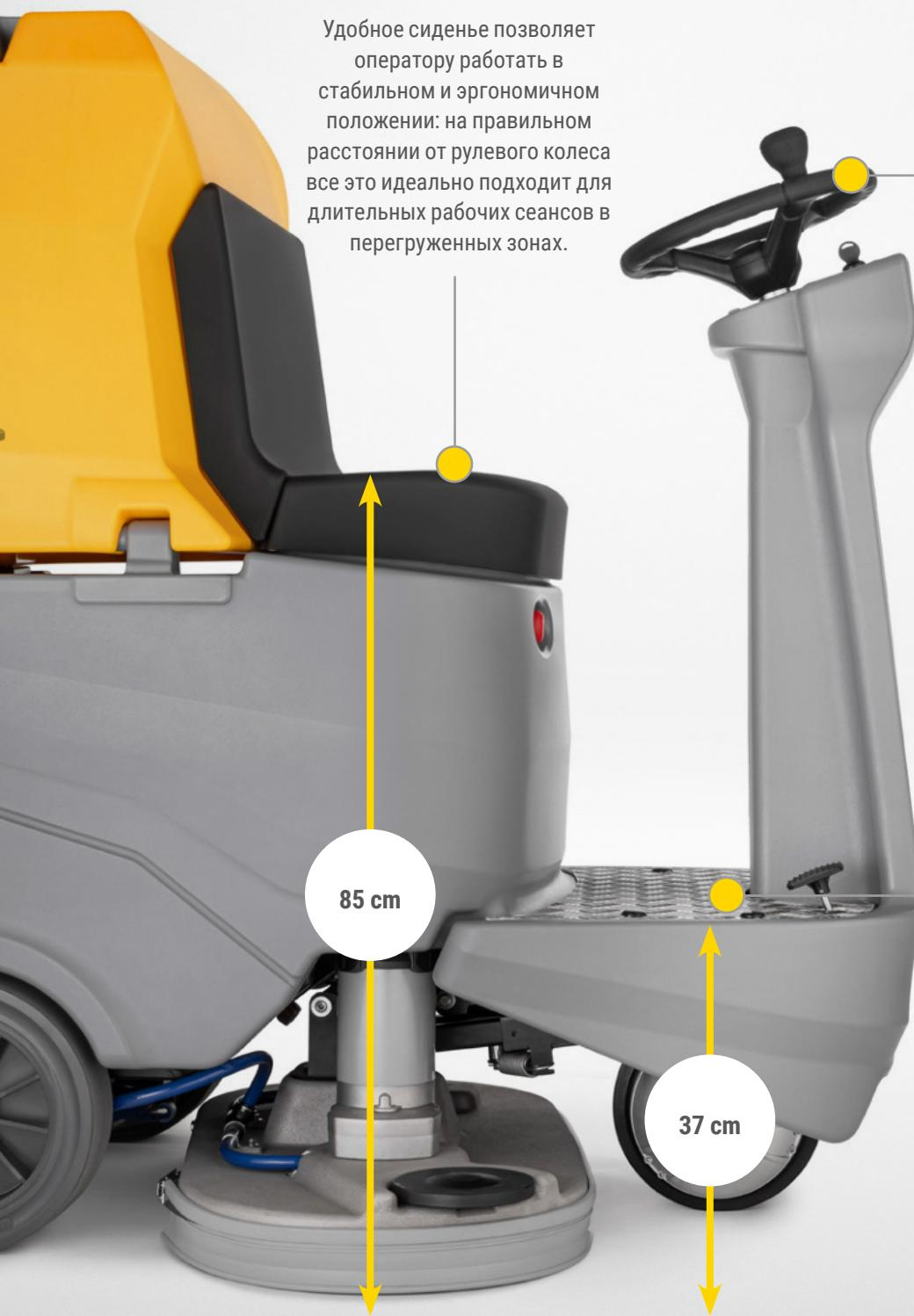
Прочная и нескользящая подножка, расположенная на подходящей высоте, легко доступна, что делает посадку на машину очень легкой и безопасной.
