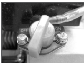
Рис. 12 Установка выключателя зажигания
