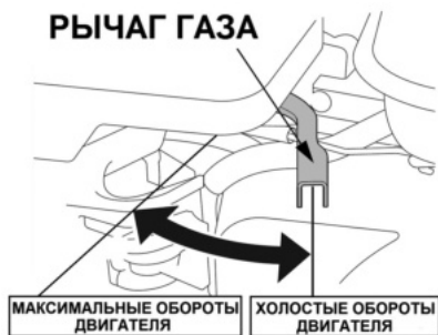
Рис. 14 Положения рычага газа
