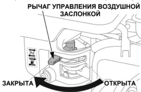
Рис. 12 Рычаг управления воздушной заслонкой
