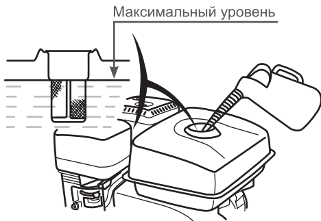
Рис. 8 Максимальный уровень топлива в топливном баке
