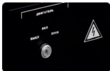
(c) Установите выключатель в положение «ВЫКЛ».
