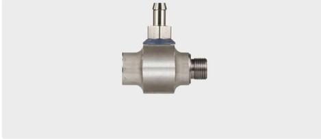
3/8" IG : 3/8" AG : наконечник 9 мм. Инжектор для нанесения химии и пены. Регулировка дозирования химии благодаря 10 сменным дозирующим форсункам (0,5 - 2,0 мм).
