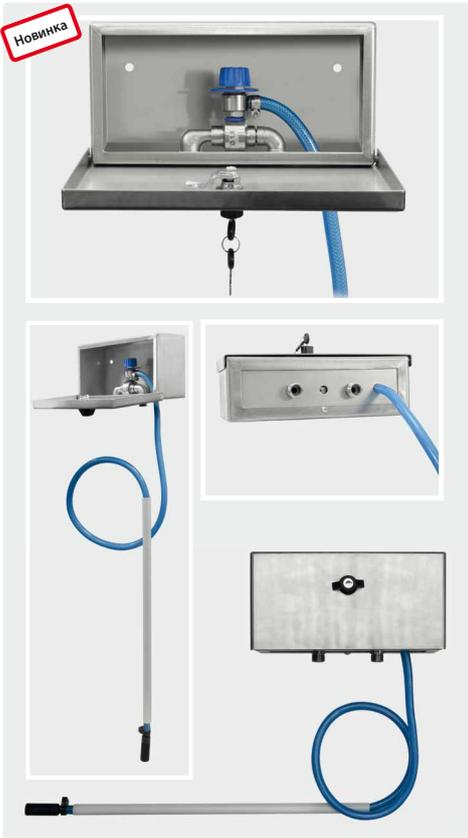
M22 AG : M22 AG. Инжектор ST-160 с дозир. вентилем ST-162, включая набор для всасывания, состоящий из всасывающего синего шланга DN 8, 1.500 мм, всасывающего фильтра ST-31 и химически стойкой пластиковой трубки, 320 мм. В закрывающемся массивном корпусе из нерж. стали.
