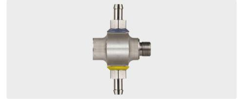
3/8" IG : 3/8" AG : 2 наконечника 9 мм. Инжектор для нанесения химии и пены. Инжектор может одновременно всасывать/смешивать до двух химических средств. Регулировка дозирования химии осуществляется благодаря 2 x 10 сменным дозирующим форсункам (0,5 - 2,0 мм).
