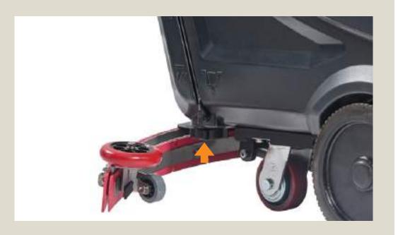
**Ежедневно:** Слейте воду из бака чистой воды с помощью пробки для слива, которая расположена внизу машины.
