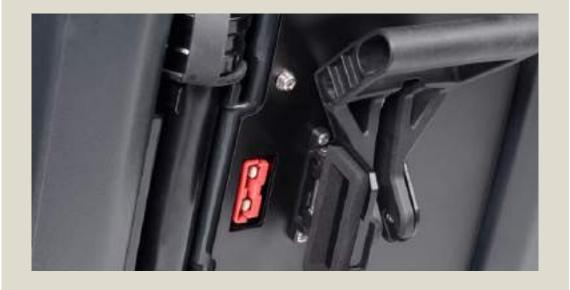
Ежедневно: Для зарядки аккумулятора, подсоедините разъем зарядного устройства к внешнему гнезду зарядного устройства машины, после чего подключите зарядное устройство к электрической розетке. Проверьте индикатор зарядного устройства, чтобы убедиться, что зарядка началась. Если машина поставляется со встроенным зарядным устройством, наклоните бак грязной воды, подключите встроенное зарядное устройство аналогичным способом.
