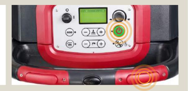
**Установите** держатель щетки / пэда под деку и нажмите кнопку OneTouch™, после чего дека опустится автоматически. Запустится вакуумный двигатель. Установите щетки кратким нажатием одного из двух выключателей.
