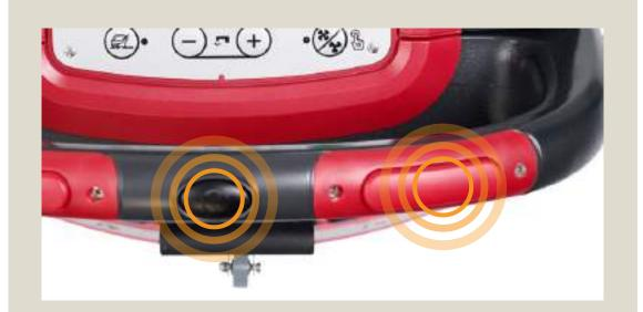
При одновременном нажатии одной из красных предохранительных кнопок и черной кнопки машина перейдет в режим движения задним ходом.
