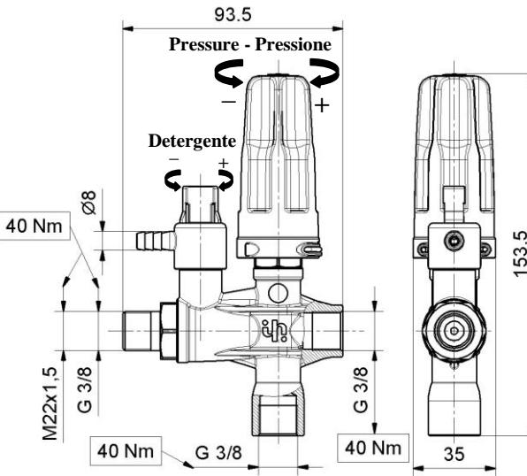
Per assicurare la tenuta interporre una rondella metallica con anello in gomma tra i raccordi o inserire un appropriato materiale di tenuta sul filetto.
