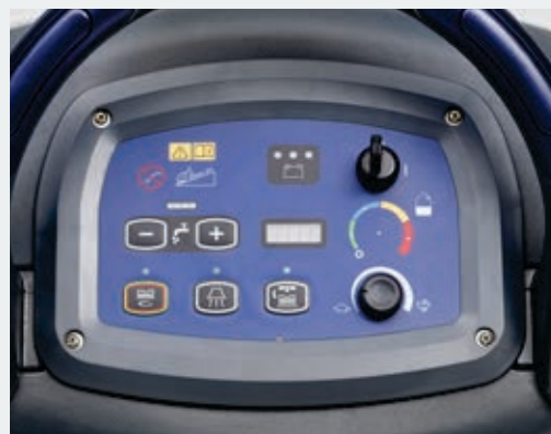
Оператор может с легкостью регулировать поток воды в соответствии с типом поверхности и количеством загрязнений на панели приборов.
