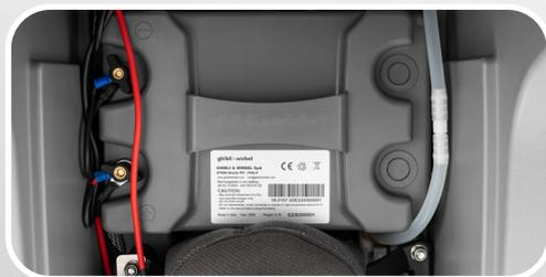
Литий-ионные аккумуляторы обеспечивают один час автономной работы в версии BC Lithium (с аккумулятором 24 В 312 Втч) и до двух часов в версии BC Lithium PLUS (с аккумулятором 24 В 547 Втч).
